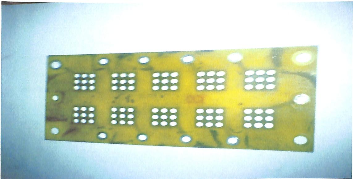
**Figure 11 : Cathode PCB Plate**
