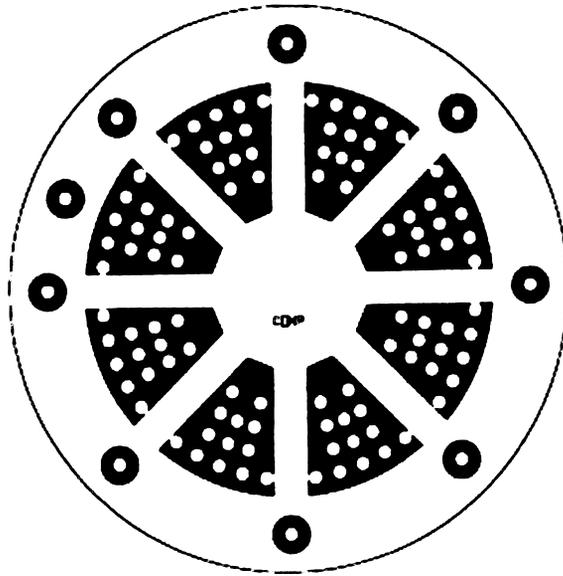
**Figure 15 : Cathode CAD diagram**
