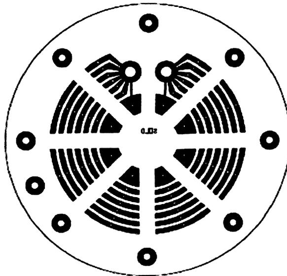
**Figure 16 : Anode CAD diagram**
