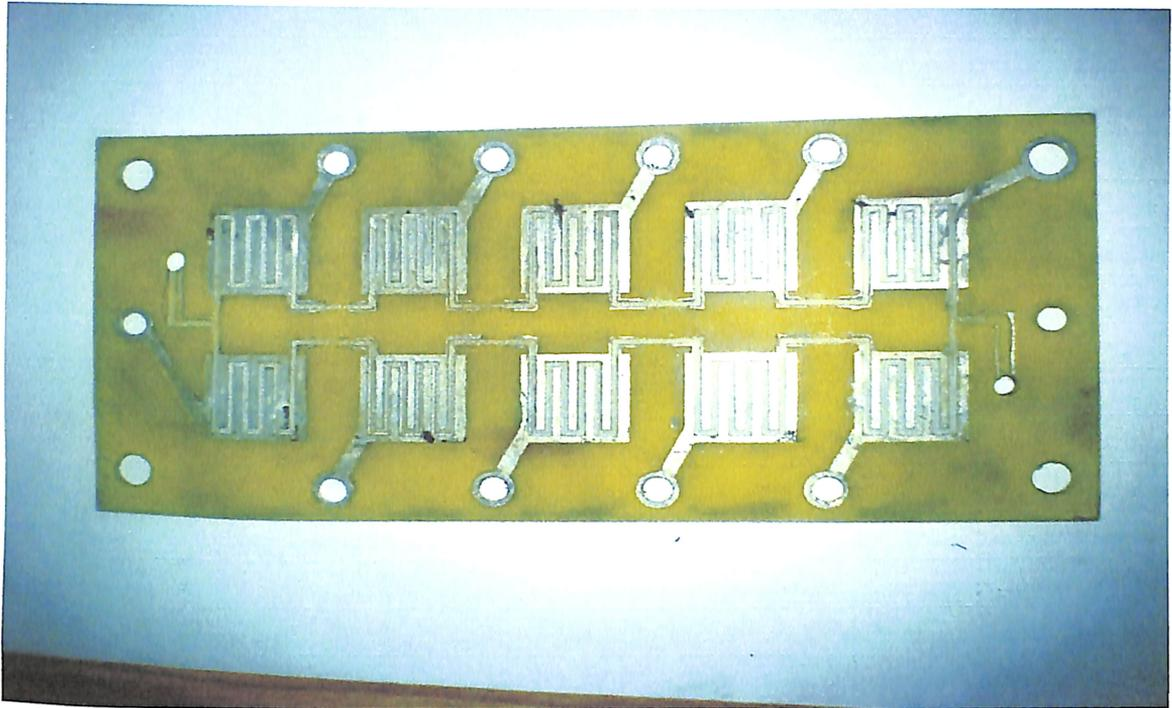
**Figure 10 : Anode PCB plate**
