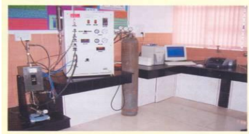
Fig. No. 11 –Gas Migration Apparatus (GMA)
