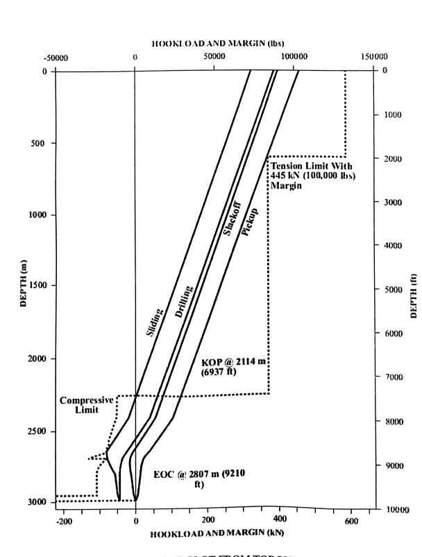
(TYPICAL HOOKLOAD PLOT FROM TORQUE & DRAG)
