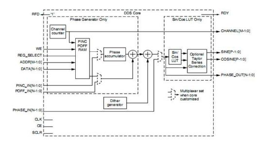
Fig.3.14. DDS Compiler Core
