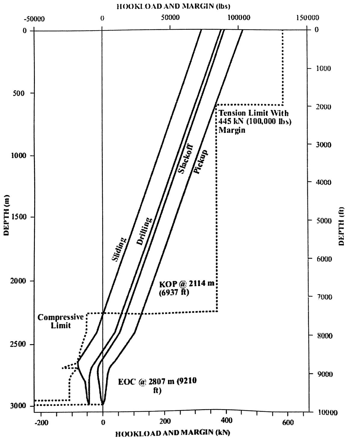
(TYPICAL HOOKLOAD PLOT FROM TORQUE & DRAG)
